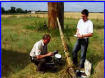
Проведення робіт по виміру дебіту свердловин
